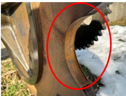
▲既設キャリングチェーンホイールの摩耗状況
